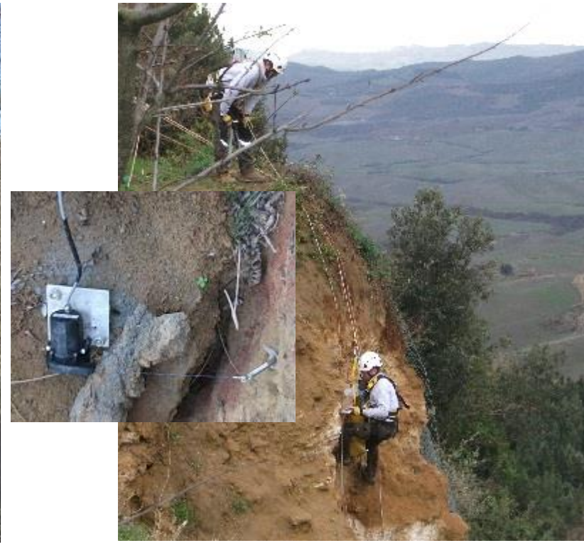
Sensore estensimetro posizionato in parete dai nostri geologi speleologi
